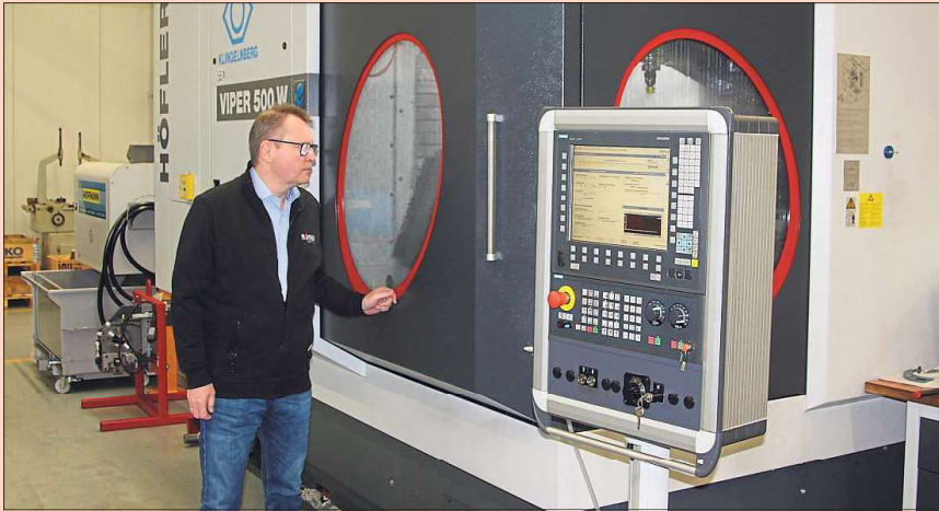
Die bisher größte, im Jahr 2019 getätigte Investition der Geschichte des Unternehmens Heinrich Höner GmbH & Co. KG aus Lette beweist, dass das Geschäft wächst. Es ist eine Zahnflankenschleifmaschine, die Viper 500, hier bedient von Geschäftsführer Horst Möllenbrock.
